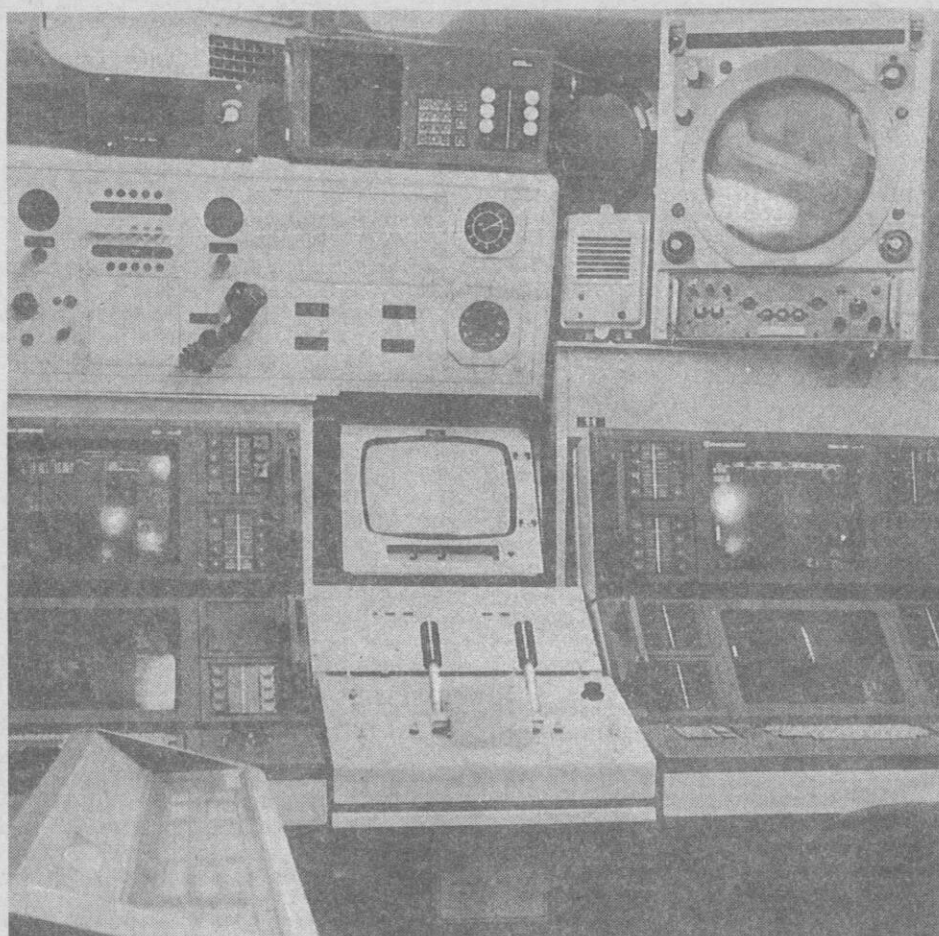
Рис. 1. Пост управления БИУС MWS-80
