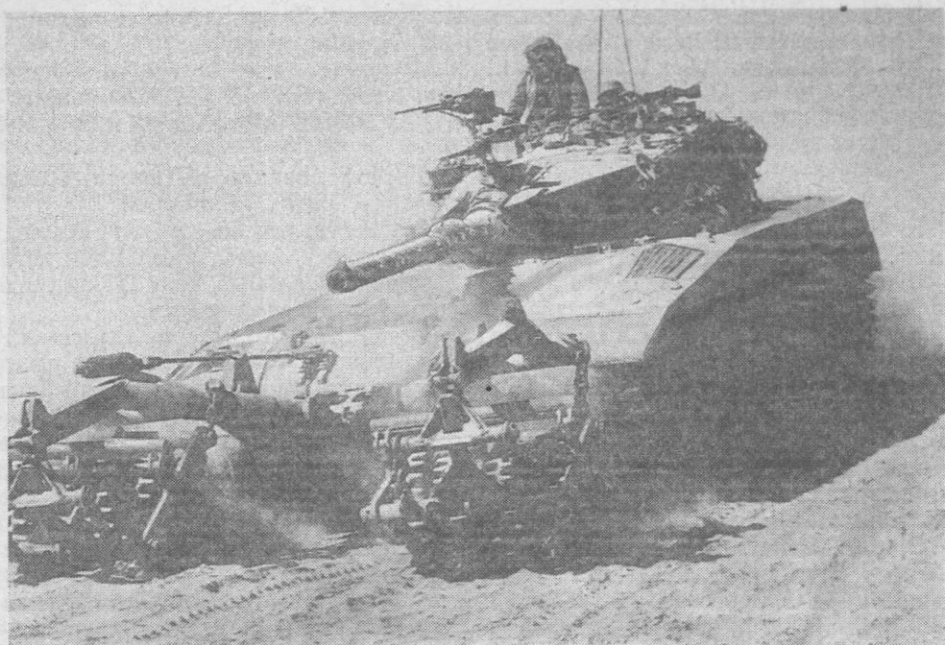
Рис. 2. Танк «Меркава» Мк1, оборудованный минным тралом
